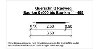
(Entwässerungslösung: freie Entwässerung über das Quergefälle in das anschließende Gelände zur breitflächigen Versickerung)
